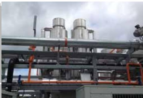
Aufbereitungsanlage nach dem Prinzip der Druckwechseladsorption (PSA)
